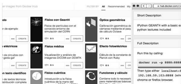
Figura 8. Kitematic mostrando las imágenes (y permitiendo la descarga pública y abierta) con todas las prácticas creadas para la asignatura de Fundamentos Físicos. Al mismo tiempo es posible ver una descripción de la funcionalidad de cada imagen y cómo trabajar con la misma
